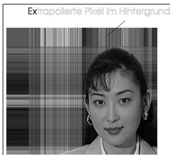
**Bild 7** Pixel-Extrapolation außerhalb der VOP-Grenzen für die Bewegungsschätzung, Bewegungskompensation und die DCT-Codierung der Textur.
