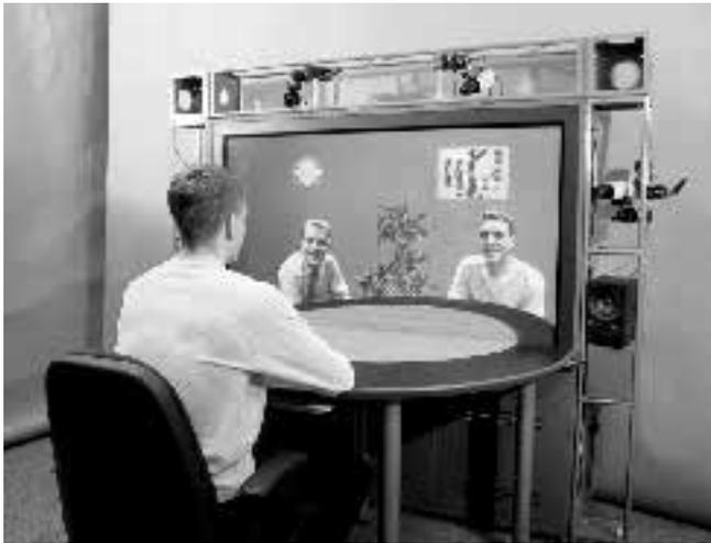
**Bild 8** Immersive Mixed-Reality Videokonferenz mit MPEG-4 (Quelle: Heinrich Hertz Institut, FhG, Berlin). Die Teilnehmer der Konferenz an unterschiedlichen Standorten sind segmentiert, mit MPEG-4 VOP's übertragen und in einer virtuellen Konferenzumgebung zusammengemischt. Es entsteht der Eindruck einer normalen Tisch-Konferenzsituation mit gegenüber herkömmlicher Videokonferenz erhöhter Telepräsenz.
